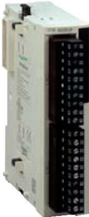
Для облегчения подключения датчиков и исполнительных устройств, а также присоединения их общих проводников, используются специальные модули распределения общих точек **OTB 9ZZ 61JP**. Как и остальные модули серии Modicon OTB, они обеспечивают сквозное соединение внутренней или сетевой шины (в данном случае - пассивное) и позволяют объединять общие проводники в две изолированные группы (2 съёмных клеммных блока с 10 винтовыми зажимами).
